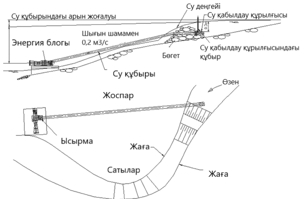
2.2 - сурет – Бөгет-туынды схема бойынша микроГЭС энергия блогын орнату схемасы
